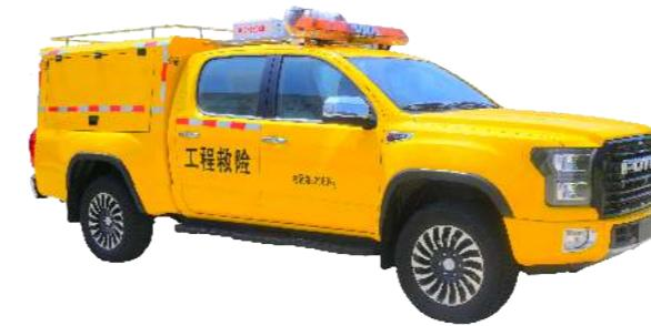
福田大将军皮卡电泵排水车500m<sup>3</sup>/h
